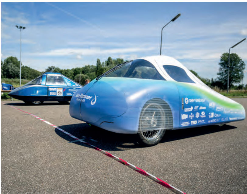
De Eco-Runner X. Het Urban Concept is een stuk groter geworden met meer functionaliteit dan het Prototype. Zo laat deze versie de bestuurder rechtop zitten, heeft het een bagageruim en heeft het dezelfde verlichting als een personenauto.
