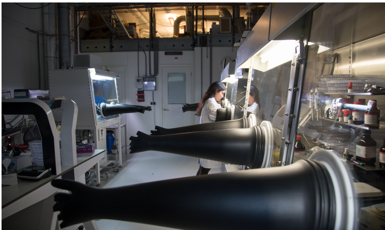
Het lab van Bruno Ehrler, waar de handschoenen om in de kasten te werken naar buiten gedrukt worden door de overdruk, die contaminatie van buitenaf voorkomt (foto: AMOLF).
