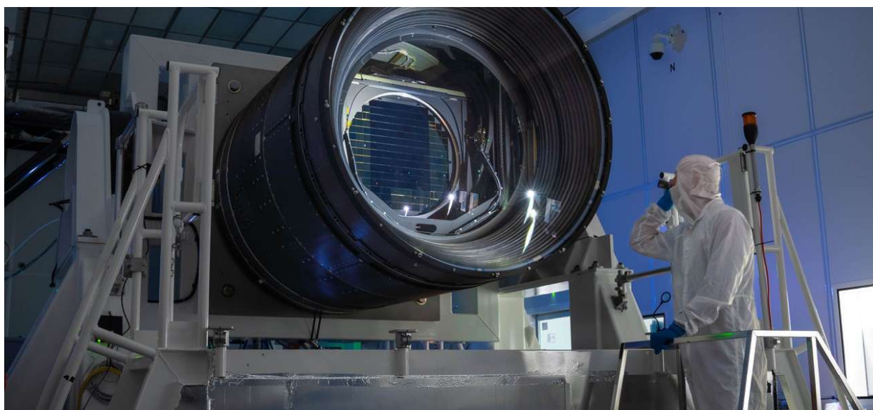
De camera van het Vera C. Rubin-observatorium weegt 3 ton en heeft een resolutie van 3200 miljoen pixels (foto: Olivier Bonin/SLAC National Laboratory).
