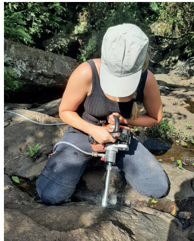
Figuur 3. Gesteentebor waar mee tijdens paleomagnetisch veldwerk de kernen worden geboord.
