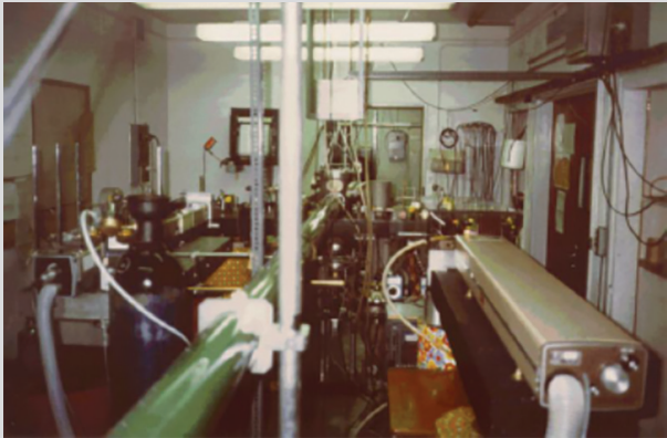
Figuur 3. Meetopstelling van Aspect en medewerkers, waar verstrengelde fotonen werden geproduceerd via overgangen in geëxciteerde calciumatomen. Foto: Institut d'Optique.
