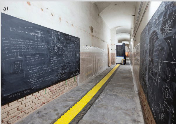
Figuur 4. Meetopstelling van Zeilingers onderzoeksgroep in de Hofburg. a) 58 meter lange gang met in het midden de bron en aan beide uiteinden de meetstations. b) Bron van verstrengelde fotonen, waar ik aan zit te werken. c) Horizontaal gepolariseerd violet licht gaat linksom door de interferometer. In het niet-lineaire kristal (ppKTP) ontstaan twee infrarode fotonen: Alice krijgt een foton met verticale en Bob een met horizontale polarisatie. d) Verticaal gepolariseerd violet licht gaat rechtsom door de interferometer. Alice krijgt een foton met horizontale en Bob een met verticale polarisatie. Wanneer diagonaal gepolariseerd licht de interferometer in wordt gestuurd, gebeurt de downconversie in een superpositie van linksom en rechtsom. De fotonen die naar Alice en Bob gaan, zijn dan verstrengeld; hun polarisatie is onbepaald en tegelijk volledig gecorreleerd. e) Bobs meetstation (Alice' meetstation is het spiegelbeeld hiervan).
