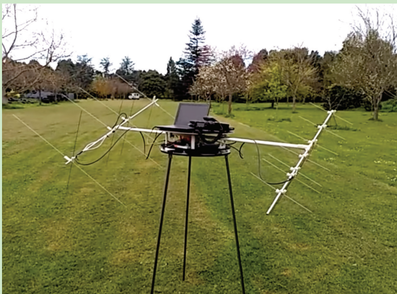
Figuur 4. Een RF monitoring station waarmee satellieten gevolgd kunnen worden in hun baan [12]. Foto: Ham Lince 1.0.
