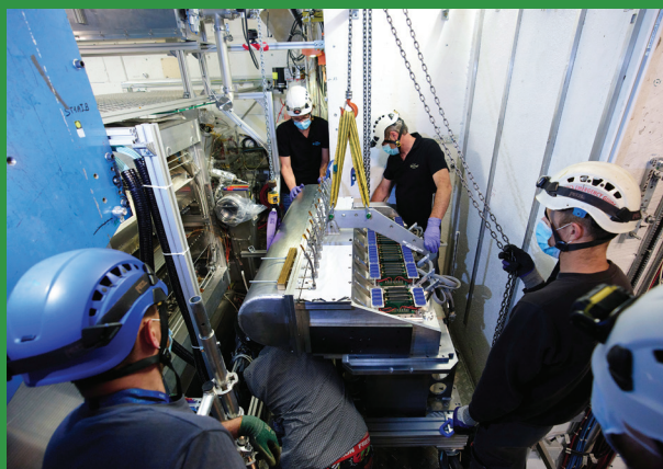
Links: de nieuwe SciFi-tracker (rechts) wacht in de experimentele hal om zijn plek in het LHCb-experiment in te nemen. Rechts: installatie van de nieuwe vertexdetector van het LHCb-experiment. Foto's: CERN.
